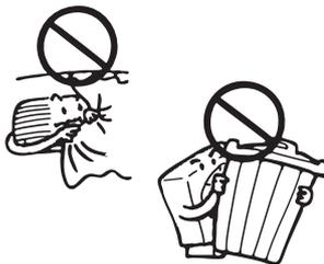
Наличие препятствий входу или выходу воздуха снизит производительность и может привести к срабатыванию защитных устройств или к его поломке.
