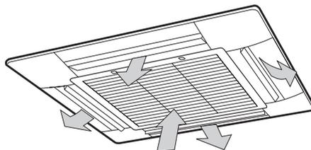
Если этот режим включен, то включается вентилятор внутреннего блока, меняя направление потока воздуха. Угол качания заслонок в каждую сторону составляет 30°. Когда кондиционер выключен или находится в режиме готовности, кнопка SWING не работает (кроме случаев, когда установлен таймер включения).
