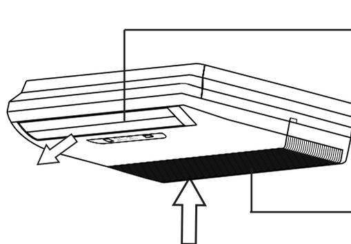
Горизонтальная заслонка, определяющая направление воздушного потока
