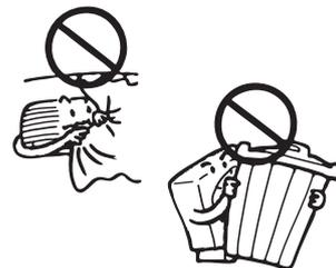
Наличие препятствий входу или выходу воздуха снизит производительность и может привести к срабатыванию защитных устройств или к его поломке.
