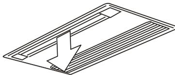
Отрегулируйте горизонтальное направление воздушного потока (влево – вправо) с помощью жалюзи, находящихся внутри системы выброса воздуха.
