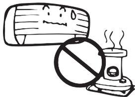
Это ведет к неполному сгоранию или деформации блока под действием тепла.
