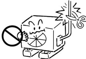
Повышенное натяжение или перегрев кабеля ведут к поражению электрическим током или к пожару.
