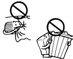
Ухудшение циркуляции воздуха может привести к снижению производительности кондиционера или к его поломке.
