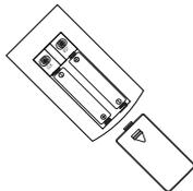
**3** При необходимости, немного растяните металлическую пружину, поджимающую батарейку.
