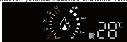
Спустя 3 секунды после завершения регулировки котел автоматически сохранит настройки.
