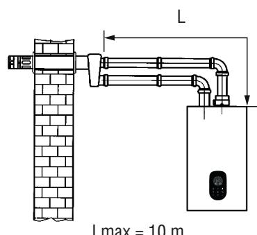
**Примеры установки с вертикальными раздельными трубами**
