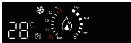
Во время поворота ручки температуры на ЖК-дисплее будет отображаться настраиваемый параметр, спустя 3 секунды после завершения регулировки котел автоматически сохранит настройки.
