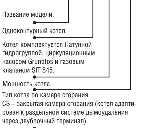
Газовые одноконтурные настенные котлы с закрытой камерой сгорания NOBBY BASE (S)/(E) снабжены системой самодиагностики и различными системами безопасности, такими, как:
