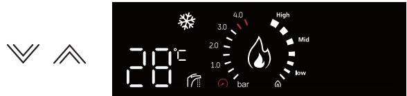
После достижения заданной температуры в бойлере косвенного нагрева котел самостоятельно перейдет из режима ГВС в режим отопления.
