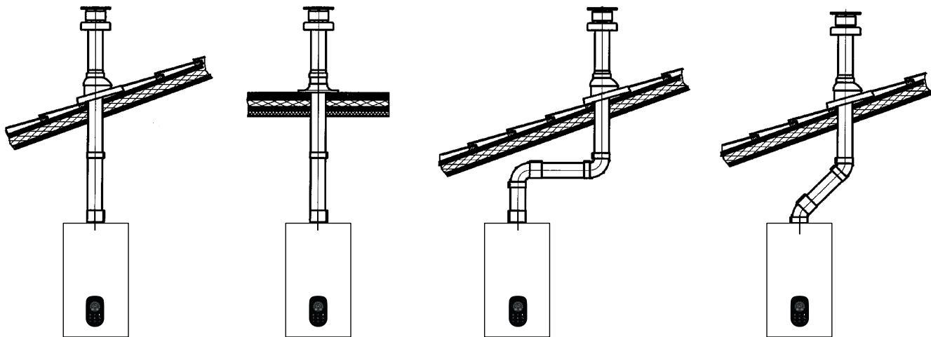
**Примеры установки с горизонтальными раздельными трубами**
