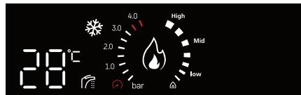
Во время поворота ручки температуры на ЖК-дисплее будет отображаться настраиваемый параметр, спустя 3 секунды после завершения регулировки котел автоматически сохранит настройки.
