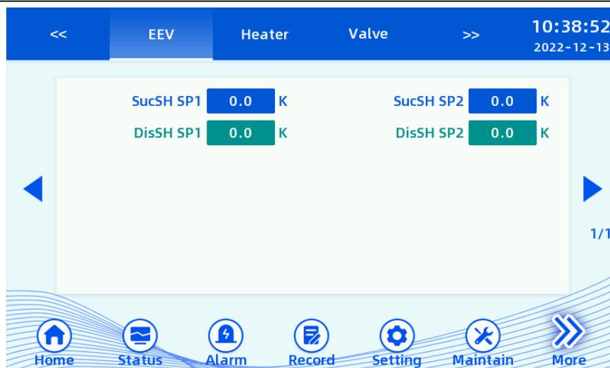
Рис. 4-51 Экран расширительного клапана
