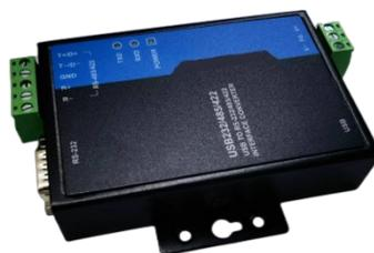
Рис. 4-3 Преобразователь интерфейсов
