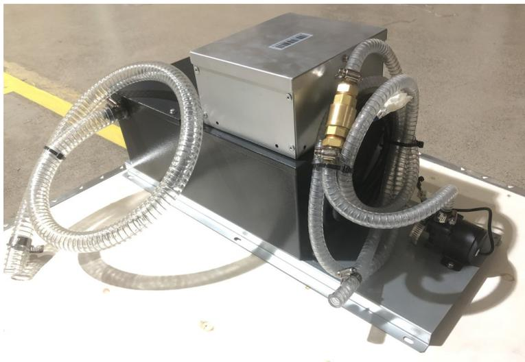
Рис. 3-42 Фото комплекта насоса для конденсата
