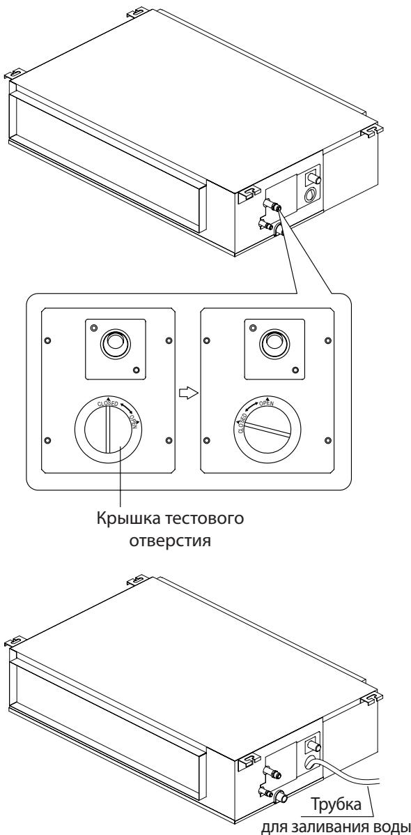
2. Включите блок в режим ОХЛАЖДЕНИЯ (COOLING). Станет слышен звук работы дренажного насоса. Проверьте, удаляется ли конденсат (после включения кондиционера может пройти около 1 мин. до начала слива конденсата, в зависимости от длины дренажной трубы). Убедитесь в отсутствии течи в местах соединений.
