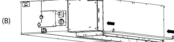
При промывке водой наружная сторона фильтра должна быть обращена книзу.
