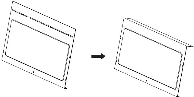
2. Поменяйте местами крышку вентиляционного отсека и раму воздухозаборной решетки.
