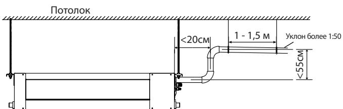
**ПРИМЕЧАНИЕ:** При объединении дренажных труб нескольких блоков подключайте их, как показано на рисунке.
