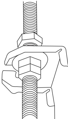
9. Навесьте внутренний блок на подвесные монтажные болты. Для предотвращения утечек расположите внутренний блок горизонтально с помощью уровня.
