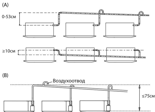
Пропустите дренажный шланг через отверстие в стене. Обеспечьте отвод воды в безопасное место, где она не может нанести ущерба и не станет замерзать.
