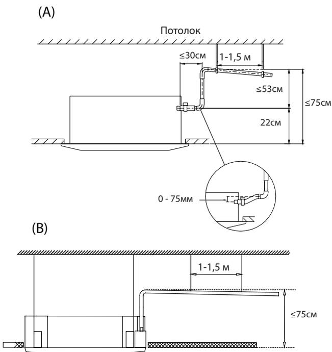
**ПРИМЕЧАНИЕ:** При объединении дренажных труб нескольких блоков подключайте их, как показано на следующем рисунке.
