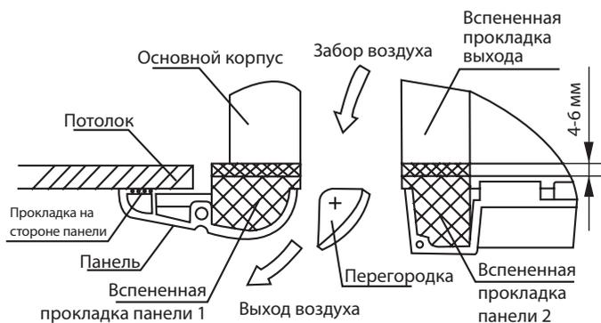
**ПРИМЕЧАНИЕ:** Если понадобится поднять блок немного выше или опустить ниже, сделать это можно через отверстия в четырех углах панели. Будьте осторожны, чтобы во время регулировки не пострадали внутренняя проводка и дренаж.
