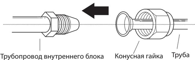
3. Затяните конусную гайку вручную до упора.
