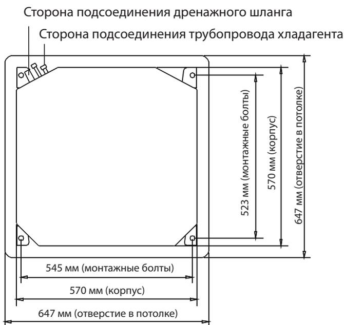
Отверстие в потолке для компактных моделей
