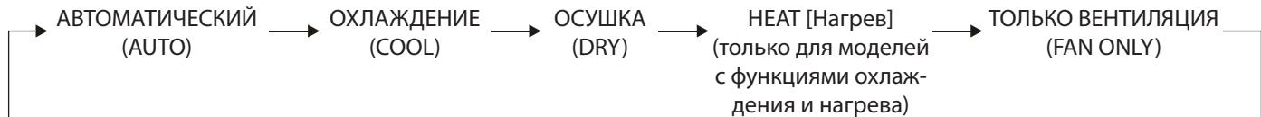
**Auto:** выбор режима осуществляется автоматически за счет отслеживания разницы между фактической температурой в помещении и заданной температурой. Скорость вращения вентилятора контролируется автоматически.
