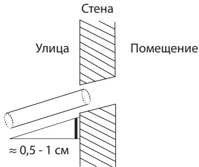
3. Поместите в отверстие защитную манжету. Это защитит края отверстия и поможет герметизировать его после завершения монтажа.
