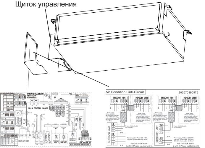
Схема электрических соединений
