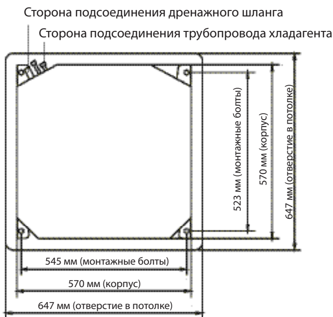
Отверстие в потолке для компактных моделей
