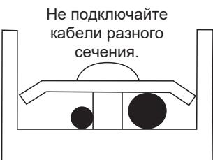
**E** Подключенный кабель электропитания следует закрепить кабельным хомутом для предотвращения его ослабления, как показано на рисунке справа.
