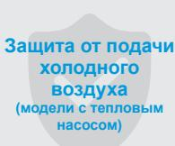
В режиме нагрева (включая нагрев в автоматическом режиме), если внутренний теплообменник не достигает определённой температуры, вентилятор внутреннего блока временно останавливается, или работает с пониженными оборотами до тех пор, пока теплообменник не нагреется до достаточной температуры.
