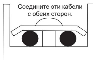
**D** На прижимайте кабели электропитания к одной стороне колодки. Не прикрепляйте к одной клемме колодки два кабеля разного диаметра. В этом случае кабели могут ослабнуть из-за разницы усилий прижима, это приведет к повреждениям (см. следующий рисунок).
