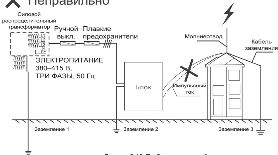
Рисунок 8-16. Требования к проводке электропитания
