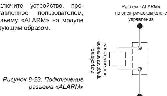
Рисунок 8-23. Подключение разъема «ALARM»
