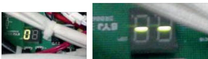
Рис. 3 Светодиодная индикация на главной плате блока при включенном питании и в режиме ожидания.
