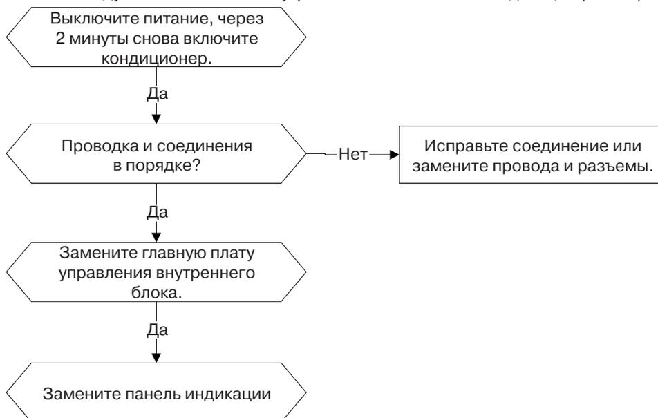
8. Неисправность привода инверторного компрессора (IDU P4/ PC04)
