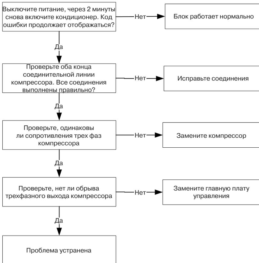
16. Неисправность микросхемы привода IR наружного блока (PC45)
