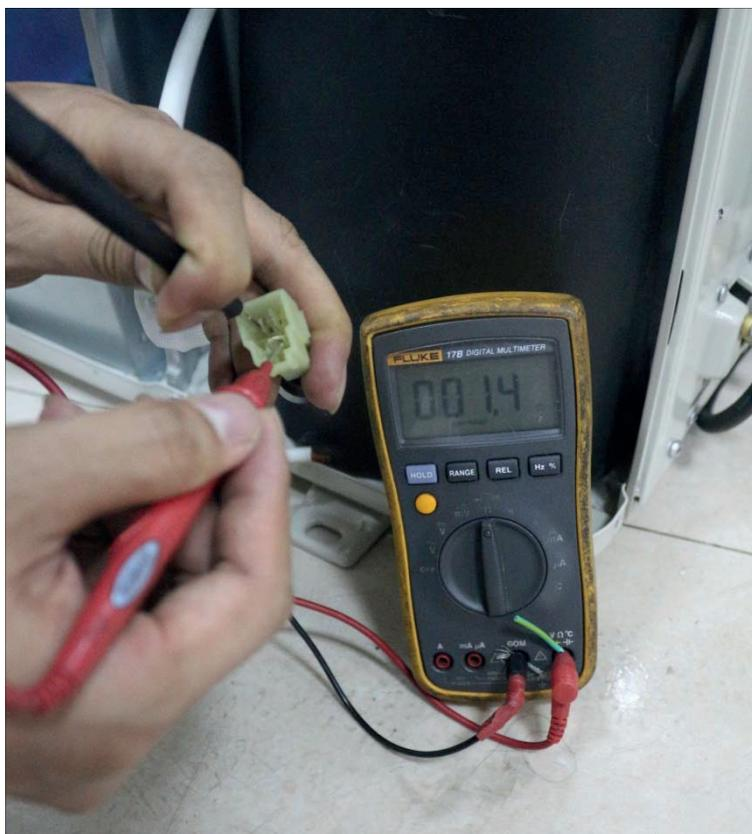
**Проверка проводимости блока электропитания**
