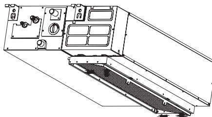
4. Фильтр должен зафиксироваться защёлками воздухозаборного фланца. Установка завершена.
