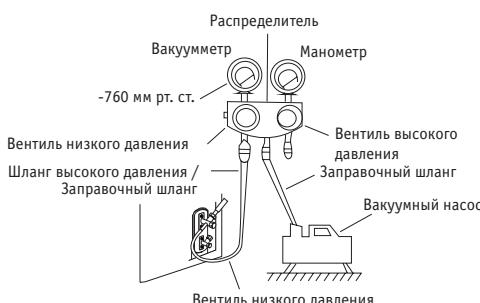
1. Присоедините к сервисному порту клапана низкого давления наружного блока заправочный шланг распределителя с манометром.
