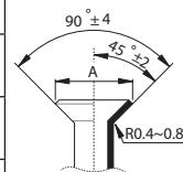
8. Снимите инструмент для развальцовки и форму для развальцовки, затем осмотрите конец трубы и убедитесь в отсутствии трещин и ровности развальцованных участка.
