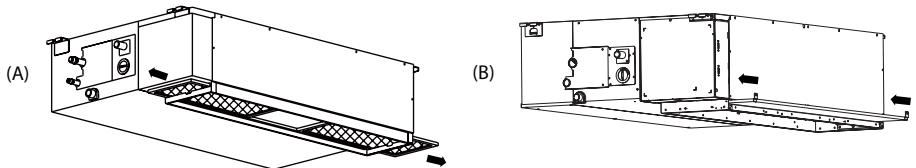
При промывке водой наружная сторона фильтра должна быть обращена книзу.
