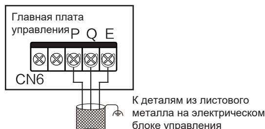
Система: Полная длина линии связи внутреннего и наружного блоков PQE не должна превышать 1200 м, с последовательными проводными соединениями, как показано ниже.
