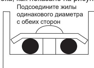
**D** Запрещено зажимать кабели электропитания с жилами одинакового диаметра с одной и той же стороны клеммы, также запрещено использовать два кабеля электропитания с жилами разного диаметра на одной и той же клемме. В противном случае, вероятно ослабление из-за неравномерного обжатия, что приведет к аварийным ситуациям, как показано на рисунке ниже.
