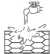
Проверьте, правильно ли установлен воздушный фильтр, и убедитесь, что воздухозаборное и воздушовыпускное отверстия внутреннего и наружного блоков не заблокированы. Если кондиционер не использовался в течение длительного времени, перед запуском обязательно очистите воздушный фильтр. В противном случае наличие пыли или плесени в фильтре приведет к загрязнению воздуха и появлению неприятных запахов. См. главу «Очистка и техническое обслуживание» для получения подробной информации.
