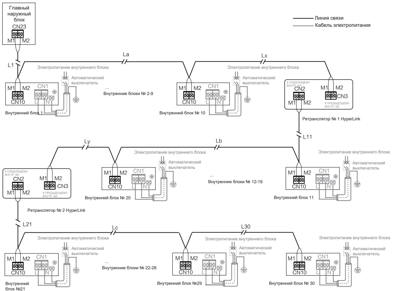
$$L1+La+Lx \leq 200 \text{ м} \quad L11+Lb+Ly \leq 200 \text{ м} \quad L21+Lc+L30 \leq 200 \text{ м}$$
