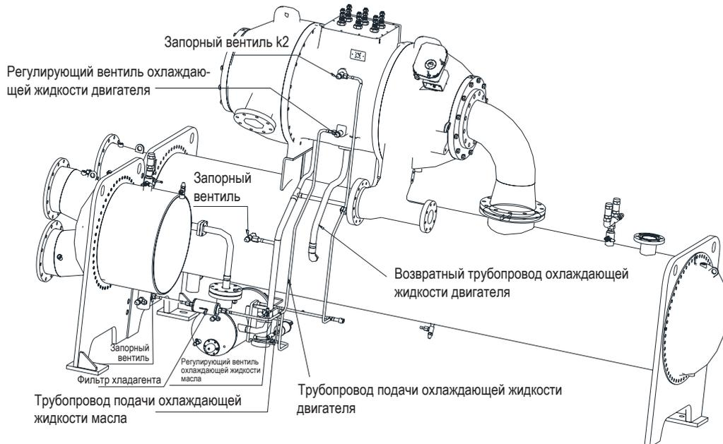
Рисунок 1.6 (b). Охлаждающий трубопровод чиллера серии с прямым приводом (600RT-1300RT)
