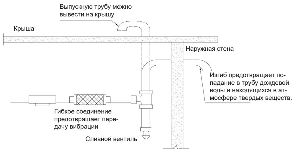
Рисунок 3.7. Подсоединение выпускной трубы предохранительного клапана
