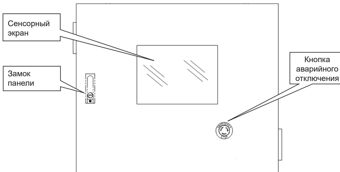
Примечание: для отключения панели управления коснитесь кнопки аварийного отключения. Для перезагрузки устройства поверните кнопку по часовой стрелке.
