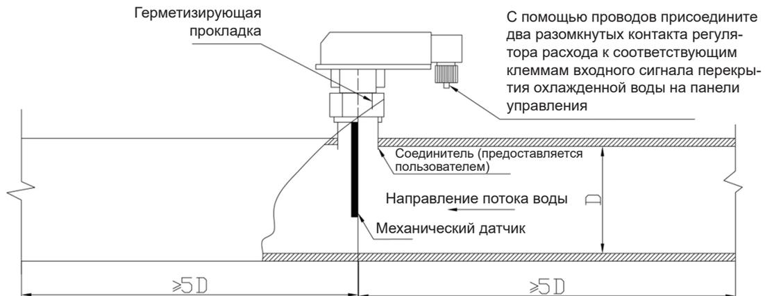
Рисунок 3.5. Монтаж регулятора расхода
