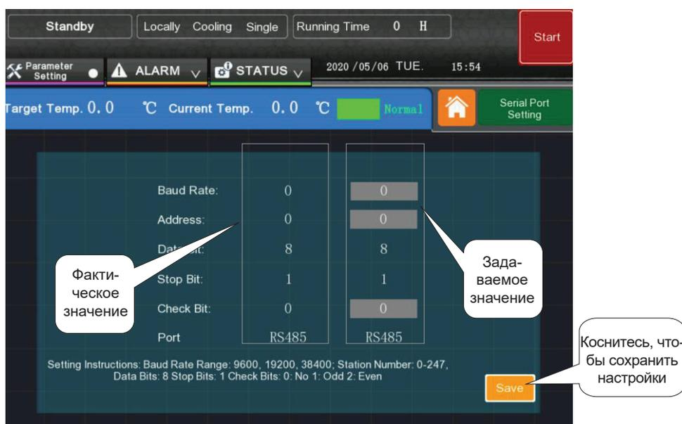
Рисунок 2.18. Экран настройки последовательного порта (у различных чиллеров может отличаться)
