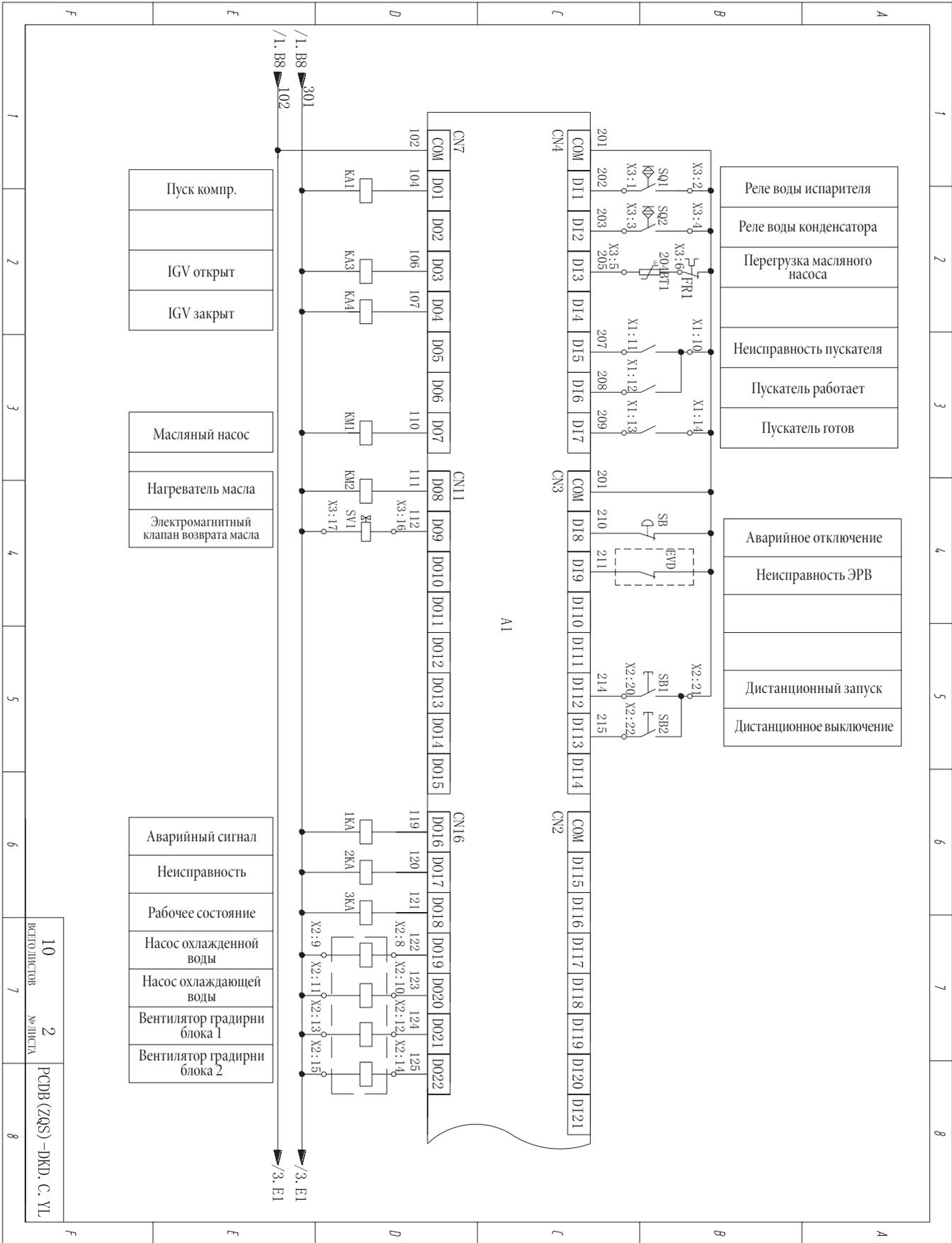
2.3.2 Принципиальная схема и схема электропроводки системы управления 2
