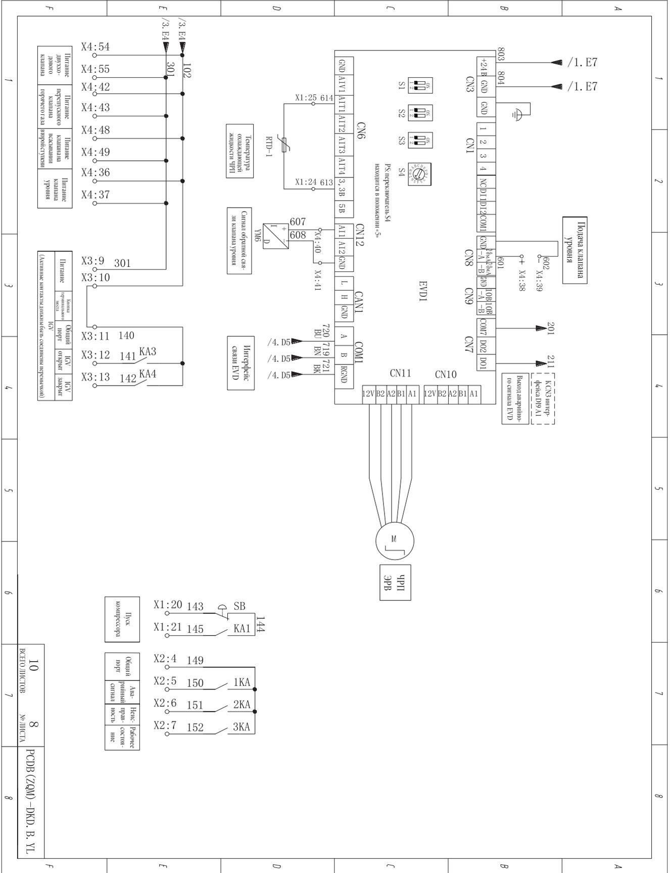
2.3.18 Принципиальная схема и схема электропроводки системы управления 18
