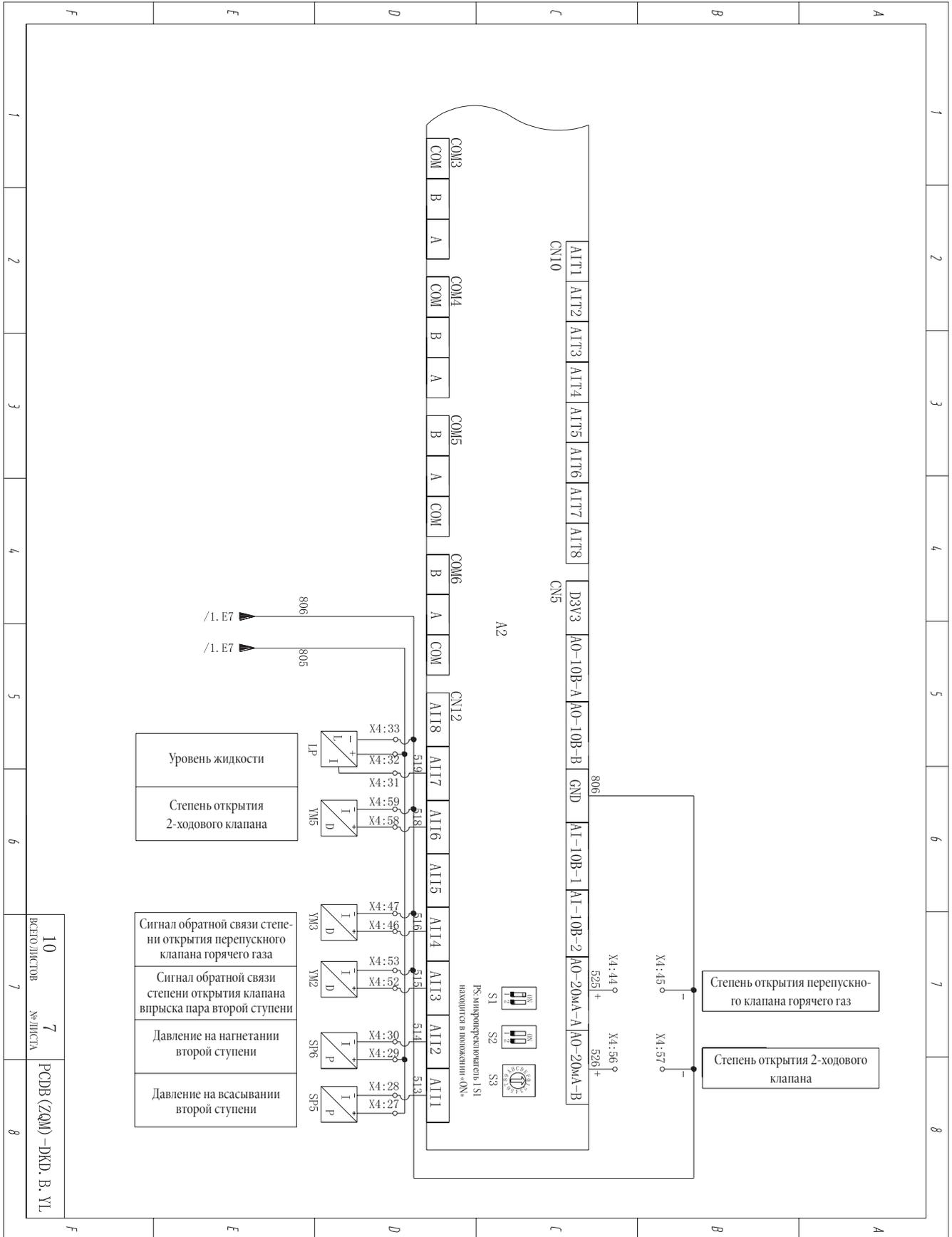
2.3.17 Принципиальная схема и схема электропроводки системы управления 17
