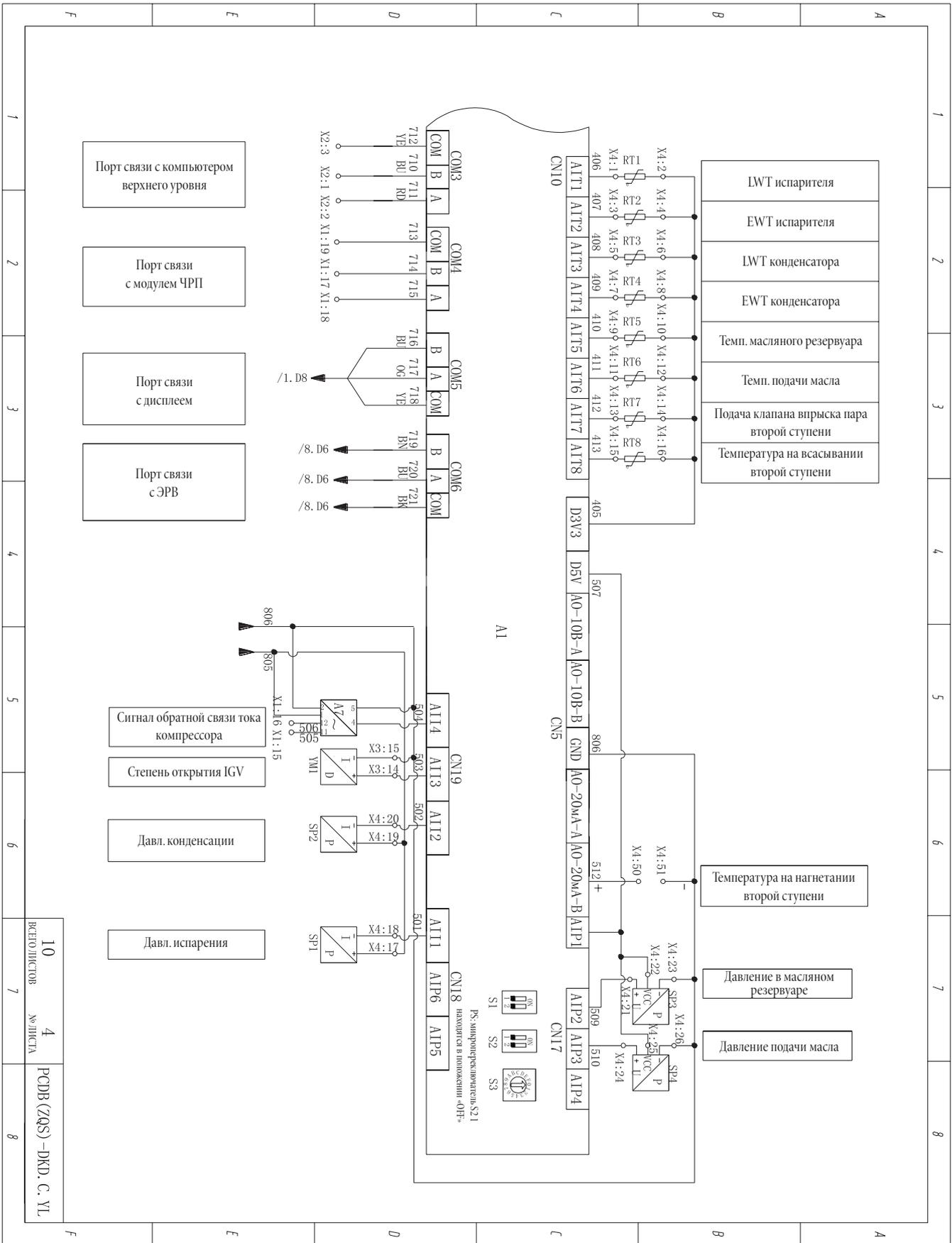
2.3.4 Принципиальная схема и схема электропроводки системы управления 4
