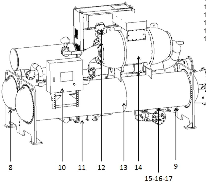
Рисунок 1.3. Схема центробежного чиллера серии с прямым приводом (600RT-1300RT)
