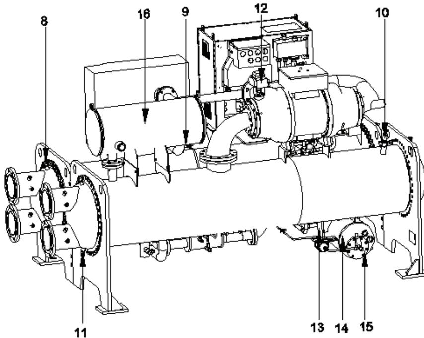
Рисунок 1.2. Схема центробежного чиллера серии с прямым приводом
