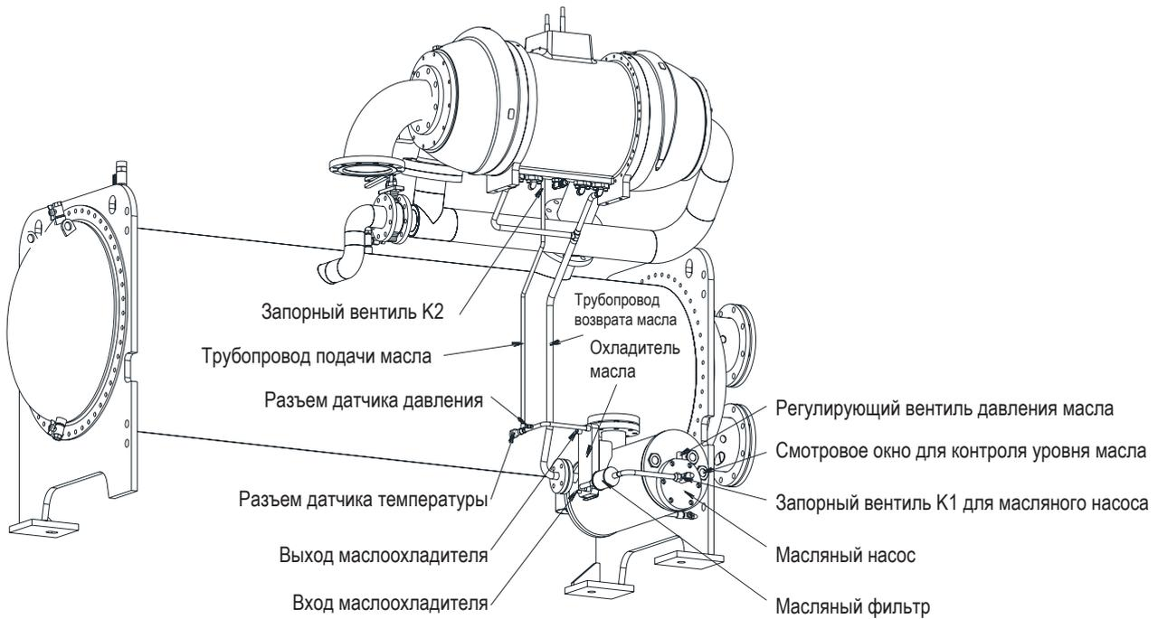
Рисунок 1.4 (а). Схема системы смазки и присоединения трубопроводов чиллера серии с прямым приводом (250RT-550RT)
