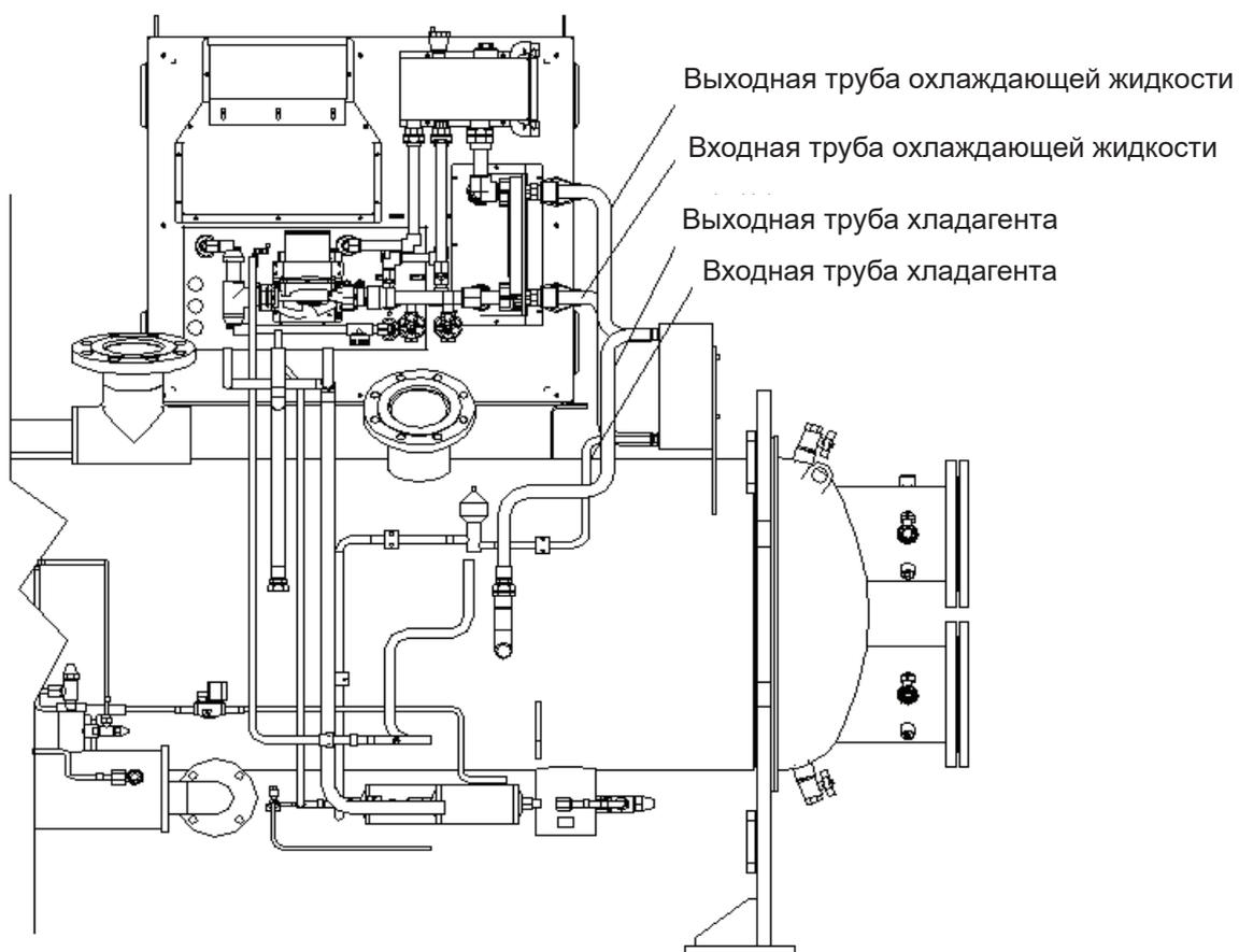
Рисунок 1.7. Охлаждающий трубопровод устройства с ЧРП
