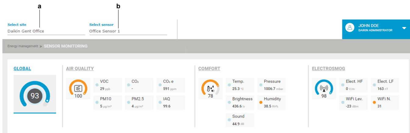
**Результат:** На экран выводятся данные слежения за показаниями (Sensor monitoring (Мониторинг датчиков)) определенного датчика IEQ за текущий день. По умолчанию сначала выводится Global (Общие) значение.
