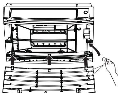
**2** Закрыв лицевую панель, сдвиньте обе задвижки до щелчка.
