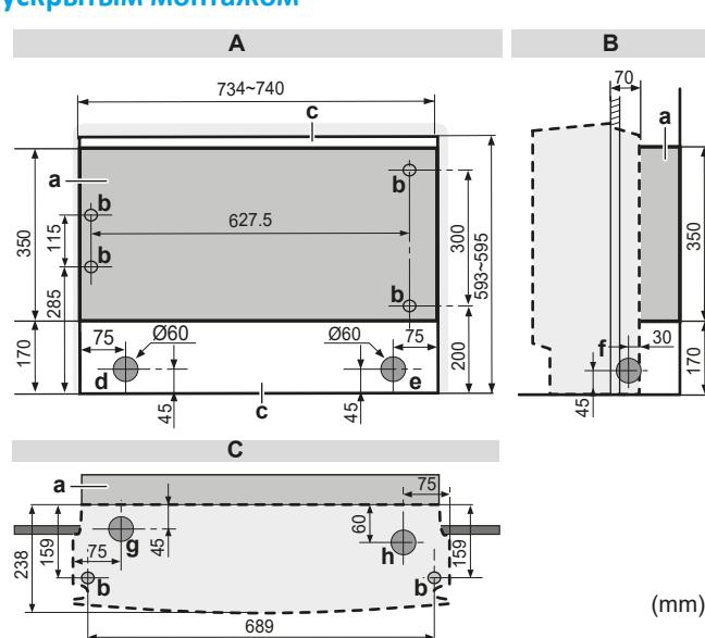
▲ 6-3 Чертеж установки внутреннего блока: с полускрытым монтажом
