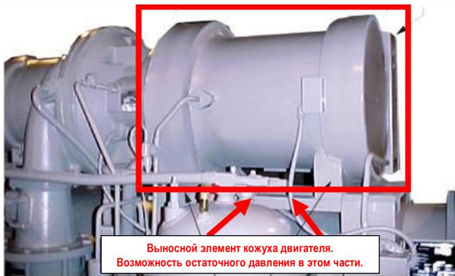
**Выносной элемент кожуха двигателя.
