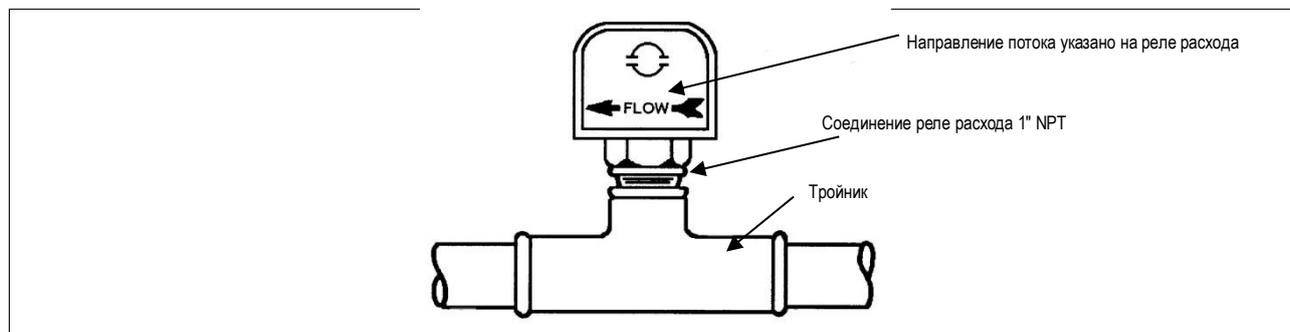
Для подключения реле расхода необходимо в панели управления агрегатом выполнить соединения в соответствии с электрической схемой.
