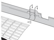
2 Нажмите обеими руками на нижнюю раму блока, чтобы закрепить его на крюках в нижней части монтажной пластины. Проследите за тем, чтобы провода нигде НЕ пережимались.
