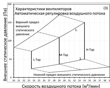
1. Верхний предел внешнего статического давления при автоматической регулировке воздушного потока
