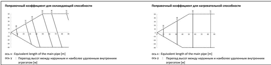
Эти рисунки иллюстрируют поправочный коэффициент мощности в зависимости от длины трубопровода для стандартной системы внутреннего агрегата при максимальной нагрузке (с установленным на максимум термостатом) в стандартных условиях.
