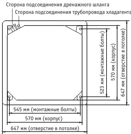
Отверстие в потолке для компактных моделей
