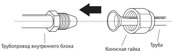
3. Затяните конусную гайку вручную до упора.
