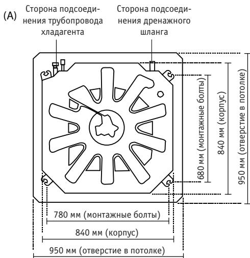
Отверстие в потолке для сверхкомпактных моделей 18–48K
