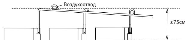
Пропустите дренажный шланг через отверстие в стене. Обеспечьте отвод воды в безопасное место, где она не может нанести ущерба и не станет замерзать.
