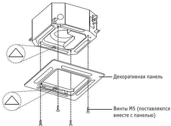
После установки декоративной панели проверьте, чтобы между корпусом блока и панелью не осталось зазора. В противном случае в зазор может проникать воздух, вызывая образование капель. (См. фигуру ниже)
