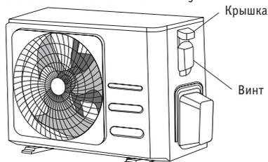
3. Подсоедините к клеммам U-образные наконечники. Совместите цвета проводов / этикетки с метками на клеммной колодке. Надежно прикрепите винтом U-образный наконечник каждого провода к соответствующей клемме.
