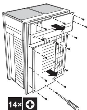
После того, как передние панели будут открыты, можно получить доступ к блоку электрических компонентов. См. раздел [«Как открыть блок электрических компонентов наружного блока»](#) [▶ 71].
