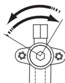
Отвинчивается против часовой стрелки
