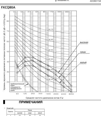
(8,6) уже выпрамене Место измерения: Безаховая камера Шум при работе различениется в зависимости от характера работы и окружающих усли Рабочее условия: Источине питаниет 220-240 У ОГЦ Охлаждение Температура возратного воздуха: 27/208, 91/208 Температура наружного воздуха: 27/208, 15/208 Температура наружного воздуха: 7/208, 6/208 Расположение микрофона 1.5 m
