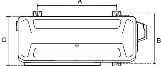
Таблица 5.1. Габариты и установочные размеры наружного блока сплит-системы (мм)
